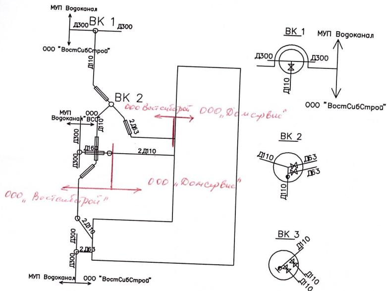
Граница ответственности за состояние и эксплуатацию сети водопровода для Абонента устанавливается: от наружной стенки фундамента здания и внутренняя разводка.
